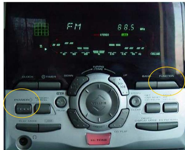
En este primer caso, vemos que el encendido opera únicamente a través del botón de encendido (Power). Esto implica que cualquier operación inicial con el sistema deberá ser precedida del uso de este botón. Cabe destacar que el botón de encendido ha sido diferenciado de los demás por una textura particular (tres puntos en relieve).
